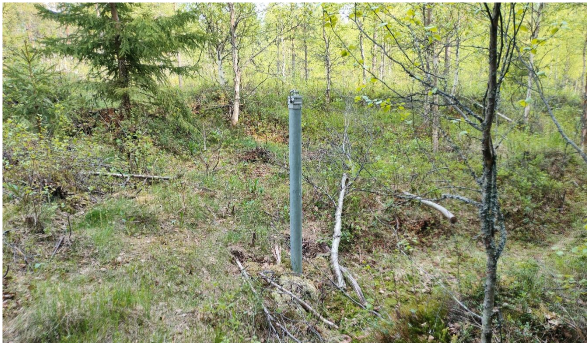
Kuva 4. Alueelle on asennettu pohjaveden havaintoputki.
