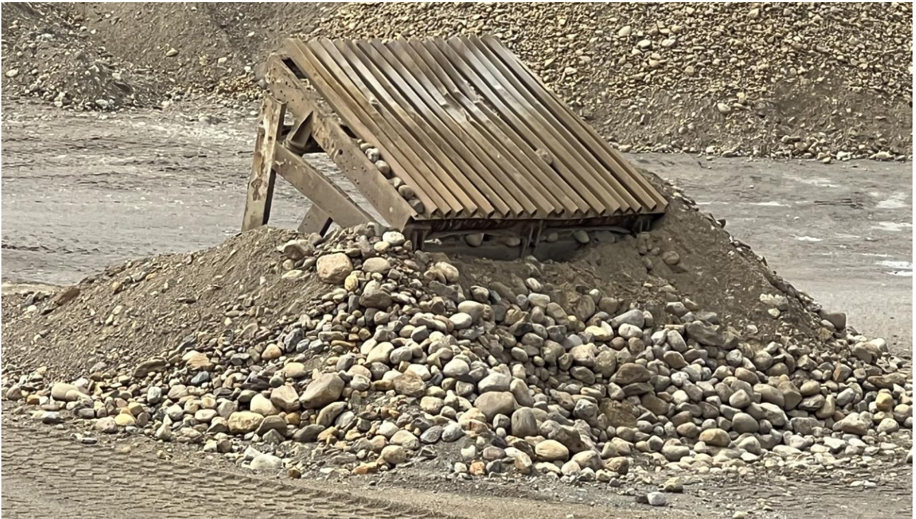
Kuva 2. Alueella käytetään, niin sanottua välppää. Maa-aines syötetään välppään, jossa hienompi materiaali siivilöityy aukkojen läpi, kun taas suuremmat kappaleet vierivät laitteen reunaa pitkin erilleen.
