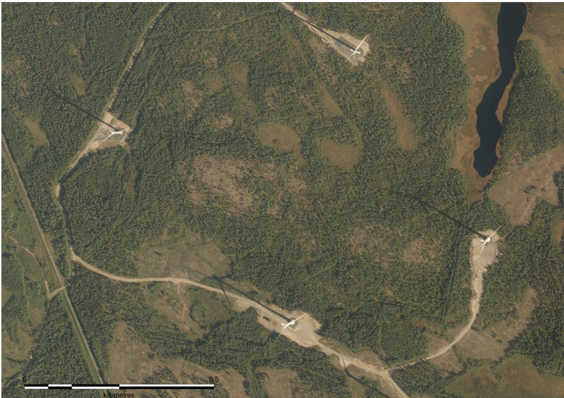
Kuva 2-7 Ilmakuvasa näkyy toiminnassa olevia tuulivoimaloita, huoltoteitä ja nostokentät. (MML, Ortoilmakuva)
