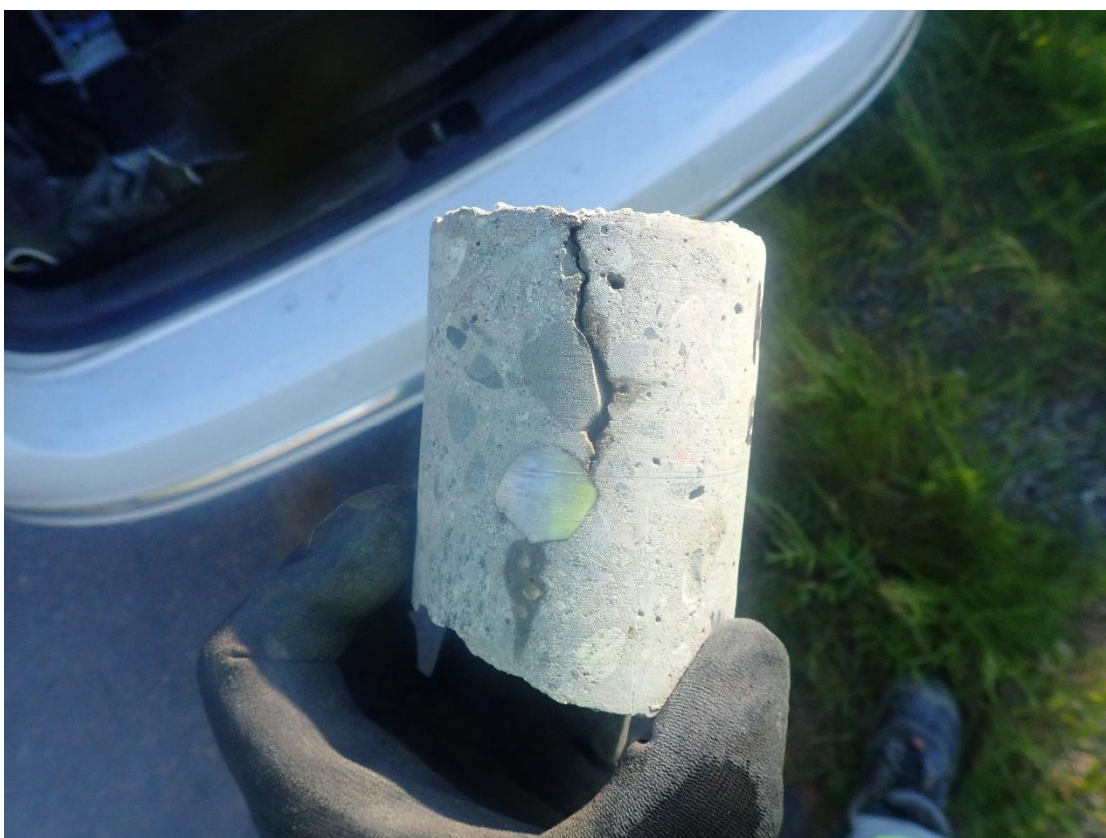
Kuva 12. Etumuri 2, pinnan suuntaa vastainen halkeama
