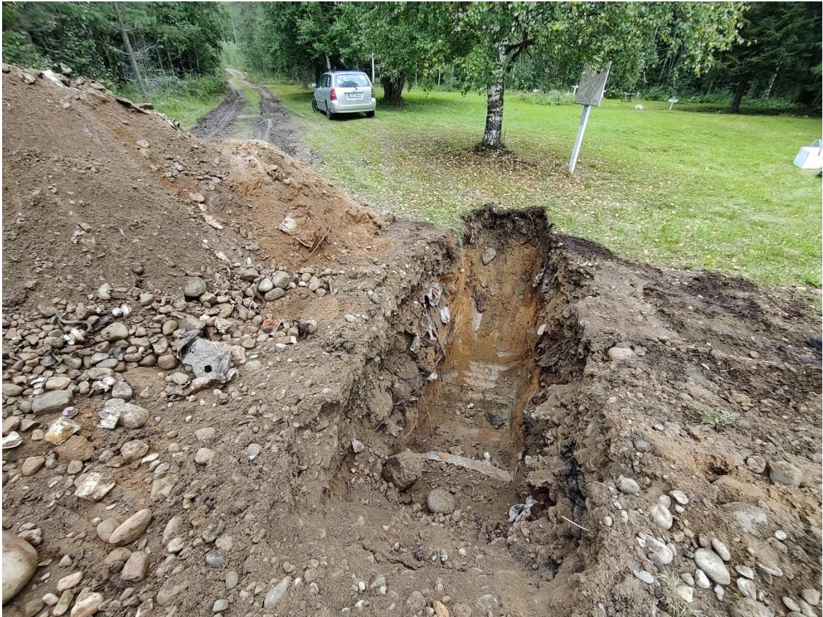
Kuva 5. Jätetäytön laajuutta kartoitettiin koekuopalla KK5. Koekuopassa olin jätetäyttöä vain metrin paksuudelta.
