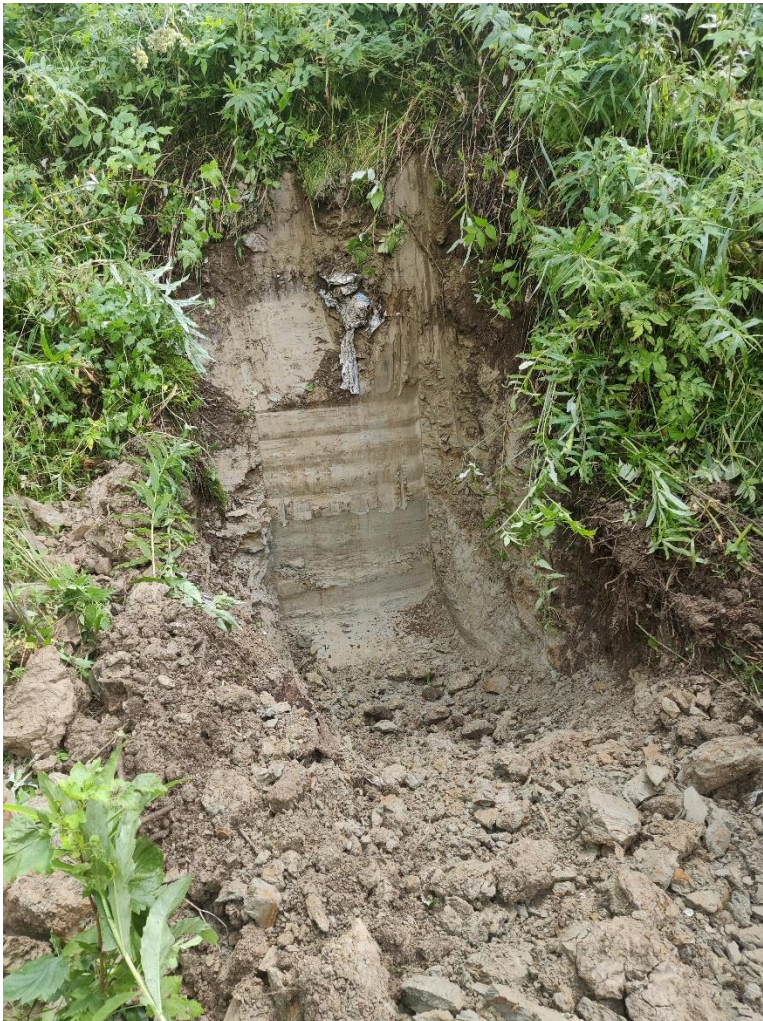
Kuva 8. Koekuopan KK9 pintamaassa havaittiin jätettä.
